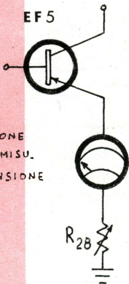
FIG. 4: PARTICOLARE STADIO EF2 E GRUPPO ATTENUATORE SINUSOIDALE. LO STESSO SCHEMA È VALIDO ANCHE PER LO STADIO EF4 E GRUPPO ATTENUATORE DELL'USCITA IN ONDA QUADRA IN LINEA DI MASSIMA.
